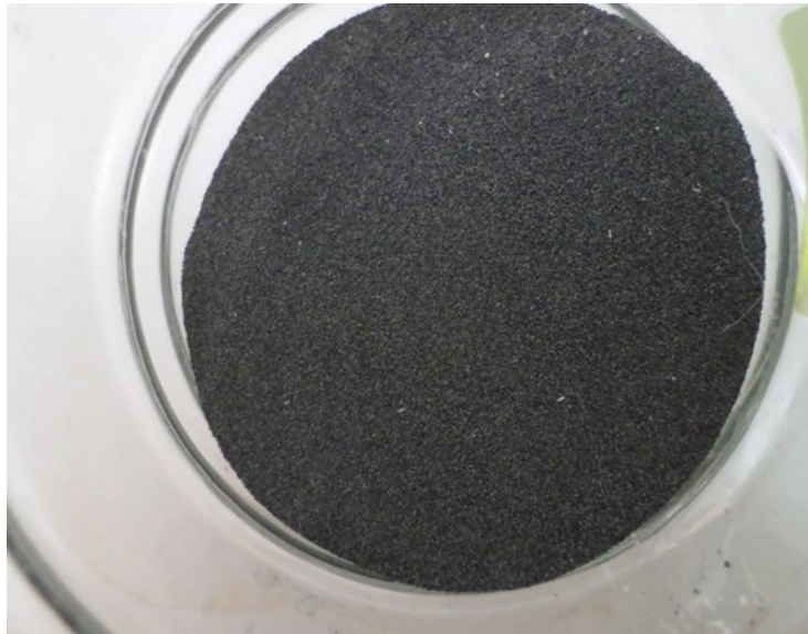
Figure III.3: les coquilles d'oeufs après calcination
