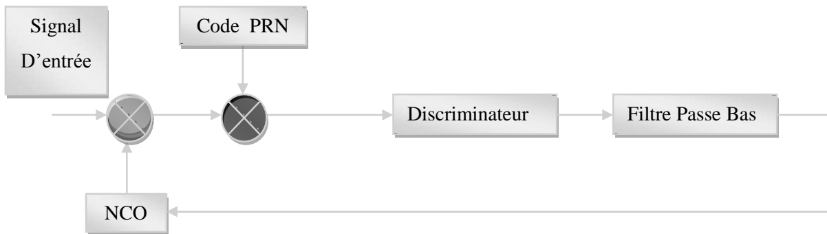
Fig. II.13 : Schéma synoptique de la boucle PLL
