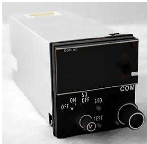
Figure III-2 : description générale de la boîte de commande
