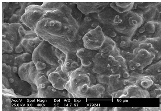
Figure 7.21 : fractographies du X60 testé à 790 °C et 2 \cdot 10^{-3} \text{ s}^{-1} , X400, X4000.
