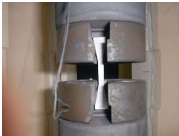
Figure 5.6 : Photo du système d'amarrage avec corps d'épreuve à l'intérieur.
