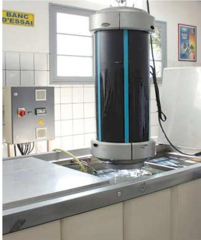
**Figure III.4 : Bac d'eau pour mesurer la résistance à la pression**
