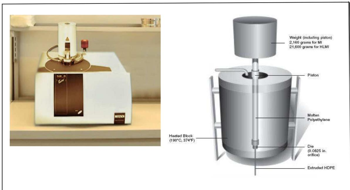
Figure III.1: Appareillage de mesure de l'indice de fluidité
