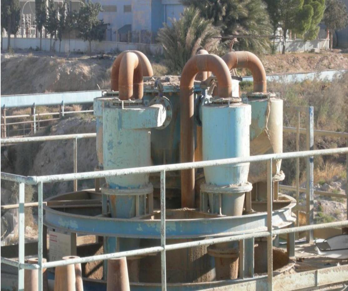
**Figure 7: Batterie d'hydro cyclone**
