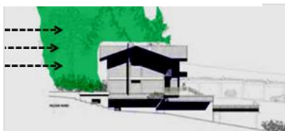
Fig. 51 : protection contre le vent
