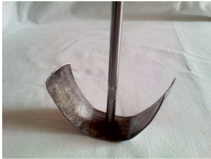
FIGURE 2.4 – La forme du melangeur type 3
