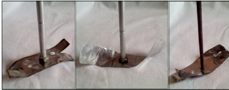
FIGURE 2.2 – La forme du melangeur type 1
