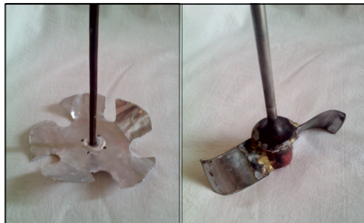
FIGURE 2.3 – La forme du melangeur type 2
