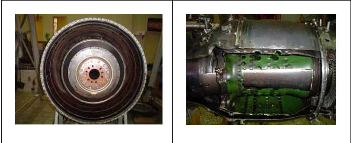
Fig. II.7. Photo transversale d'une chambre annulaire
