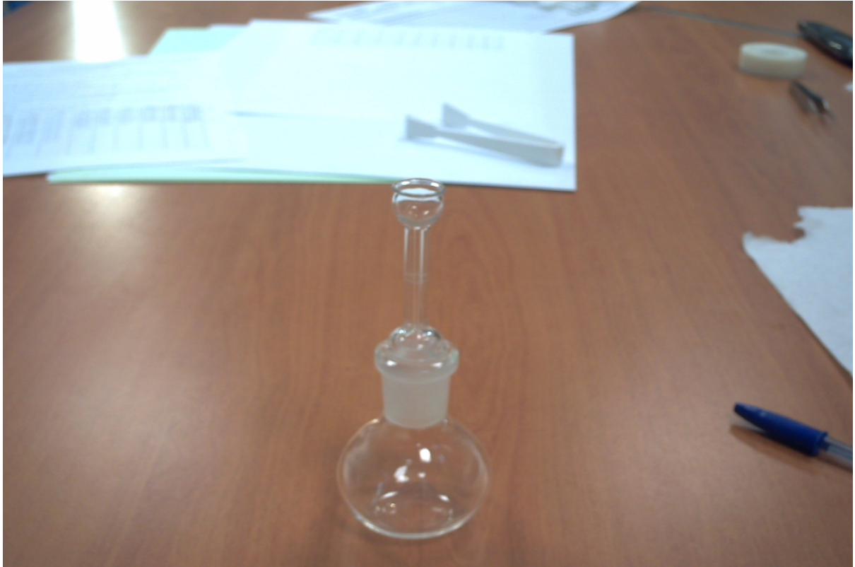
Figure 2.38 : un pycnomètre pour déterminer la densité de \text{Yb: LiGd(WO}_4)_2 (1 at. %).
