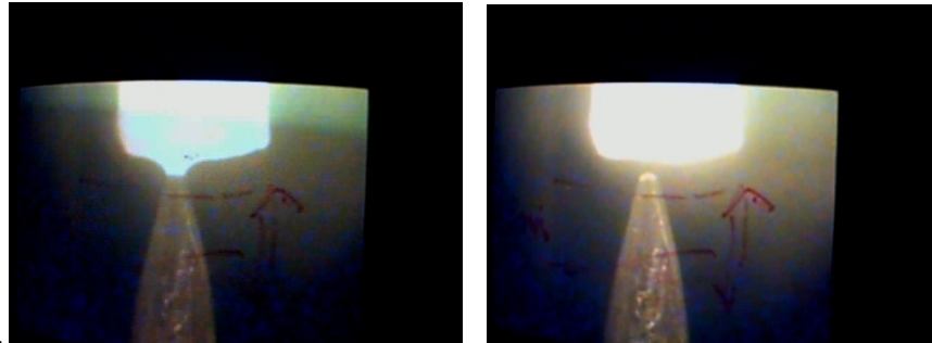
Figure 2.17 : fin de tirage, et déconnexion de la fibre cristalline
