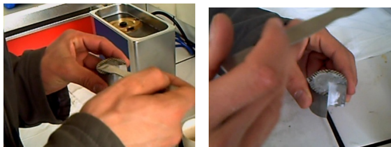
Figure 2.29 : Collage des fibres sur une pièce métallique pour le polissage
