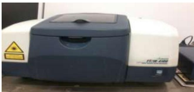
**Figure (II-2) :** Spectrophotomètre infra rouge (JAS.C.O FT/IR-4100).
