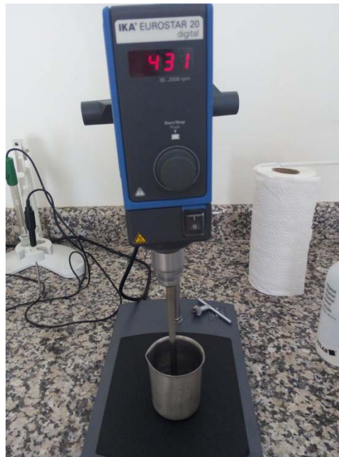
Annexe 8 : Agitateur à hélice IKA EUROSTAR 20.
