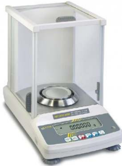
Annexe 1 : Balance analytique KERN 220-5DM.
