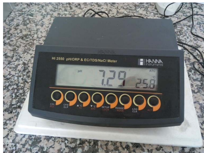
Annexe 6 : Conductimètre et pH mètre HANNA HI 2550.
