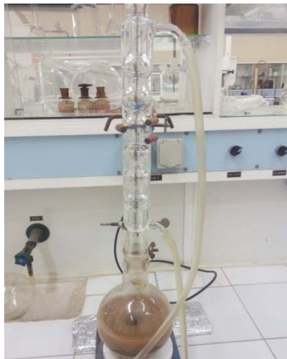
Figure 4-7 : Montage de la macération à froid sous reflux.
