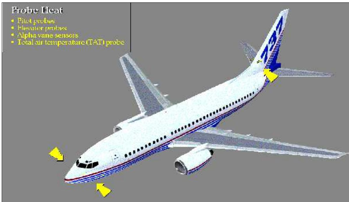
*Figure (III-17) : Les différentes sondes de la chaleur sur l'avion*
