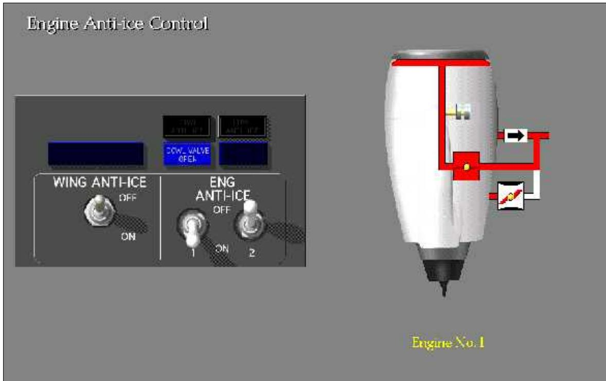
**Figure (IV-12) : L'ouverture complète de la valve de (TAI)**
