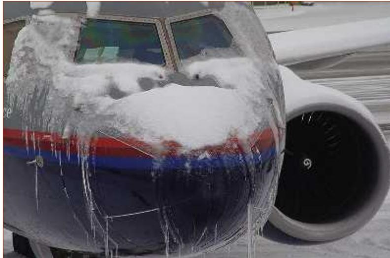
**Figure (II-01) : Une augmentation du poids de l'avion**
