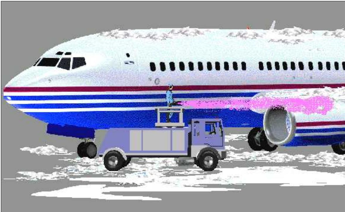
**Figure (IV-15) : Le traitement de dégivrage au sol**
