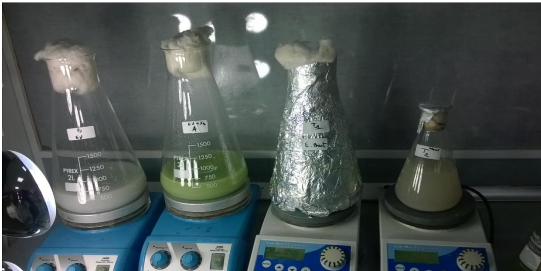
Figure 6. Dispositif expérimental (série de quatre Erlen dans 4 situations : (A) Eaux usées contenant Chlorella sp, (B) Témoin, (T1) Eaux usées maintenues à l'obscurité, (T2) Eaux usées exposées à la lumière.
