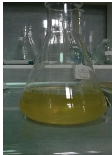
Figure. 15 Aspect des eaux de rejet après traitement aux microalgue
