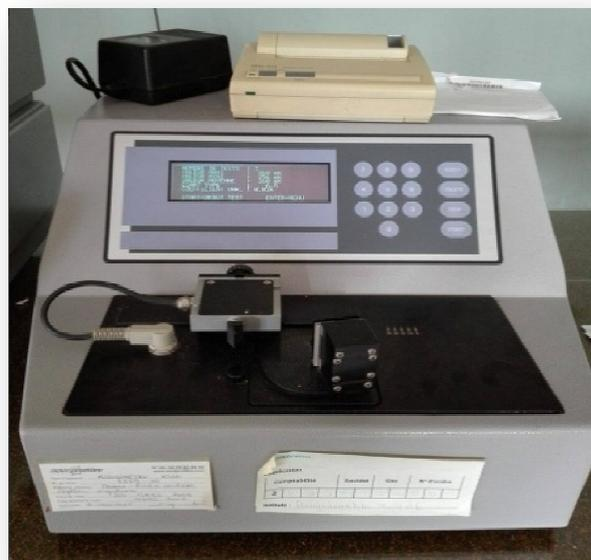
**Figure 2.3 : Un rigidimètre**
