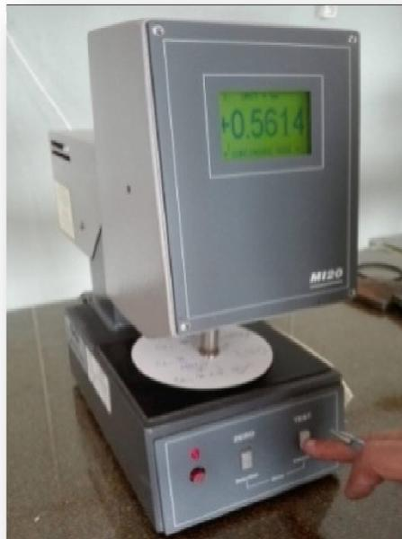
**Figure 2.1 : Un micromètre**
