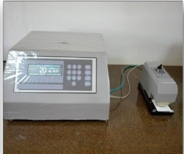
**Figure 2.7 : Rugosimètre/ Porosimètre**
