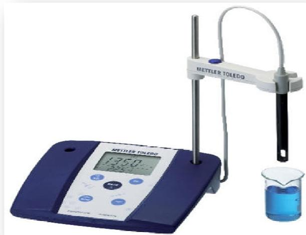
**Figure 6 : Conductimètre**
