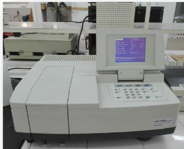
**Figure 7 : Spectrophotomètre UV**
