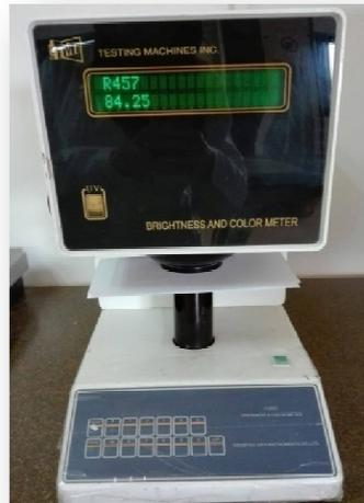
Figure 2.4 : Un réflectomètre
