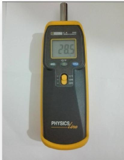
**Figure 2.11: Thermo-hygromètre**
