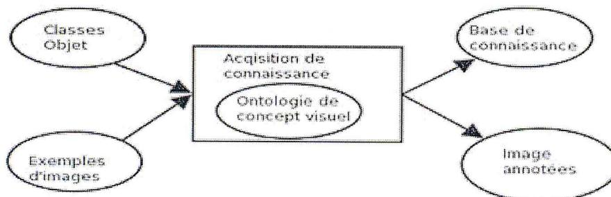
**Fig.2-7 :diagramme d'étape d'acquisition des connaissances**
