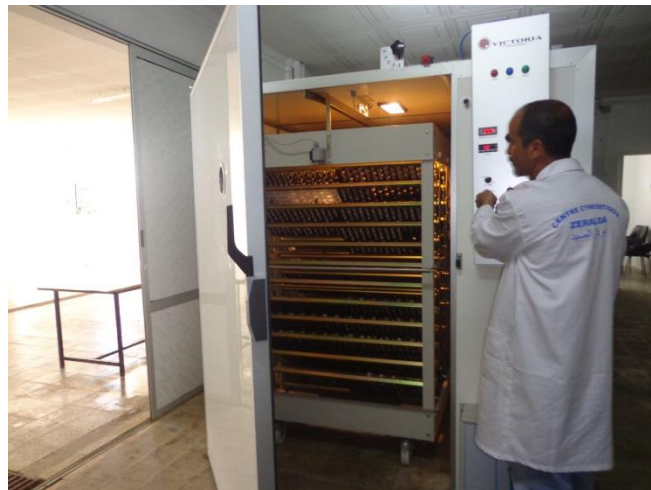
Fig.10: Incubateur à grande capacité de type Victoria acquis en 2014, équipé d'un ventilateur, d'un humidificateur et d'une résistance assurant les conditions d'incubation en plus du retournement automatique des œufs (originale 2016).
