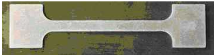
Figure III.1 – Exemple d'éprouvette de traction en alliage d'aluminium.
