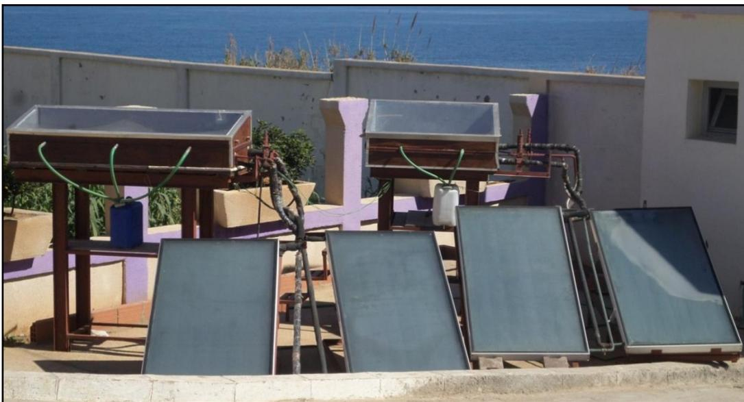
**Figure. 2.5** : Dispositifs expérimentaux couplé à des capteurs solaires plans.
