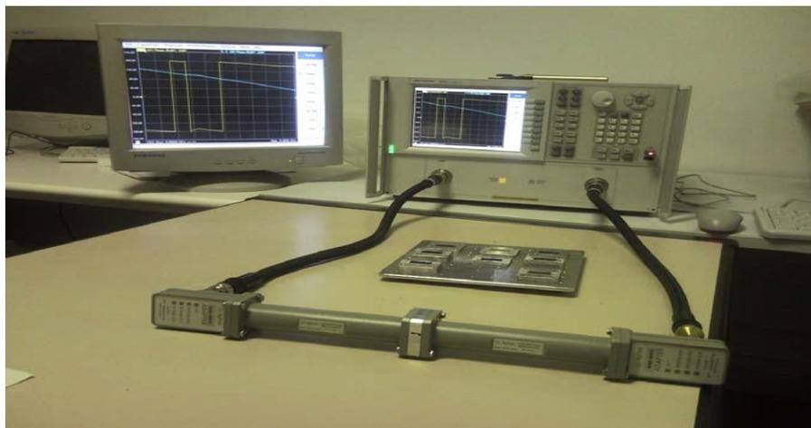
Figure 3.1 : Dispositif de mesure des paramètres S.
