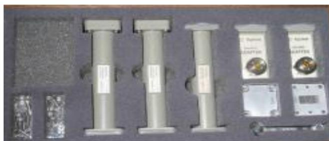
Figure 3.3 : outils de calibration d'un guide d'ondes bande X.
