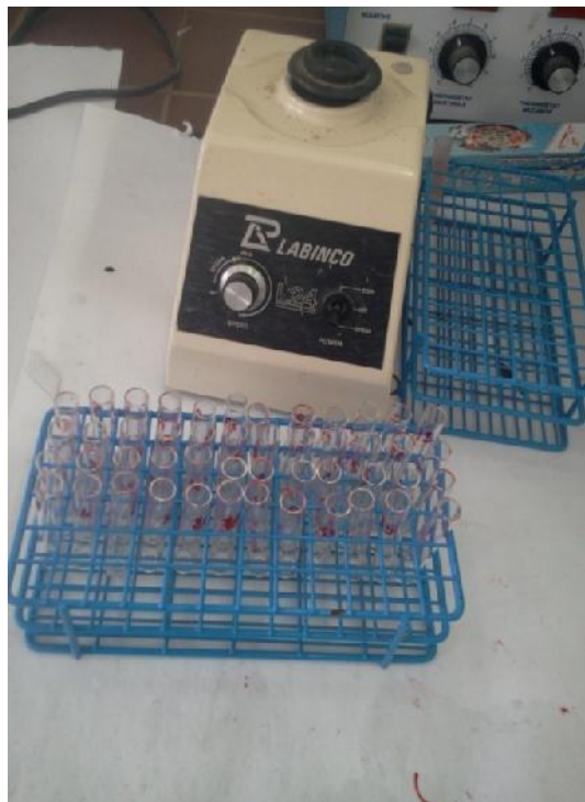
Figure 6.40 : Mélangeur ou vortex et portes tubes
