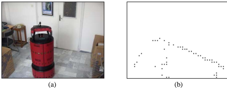
Figure 4.20 Création d'une carte locale basée sur le capteur laser
