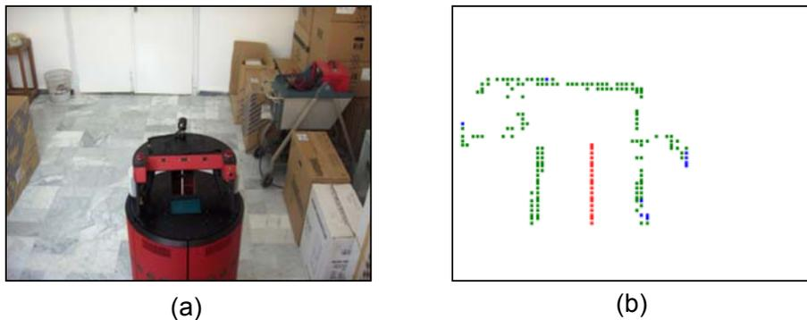
Figure 4.19 Création de la carte d'environnement utilisant le capteur laser
