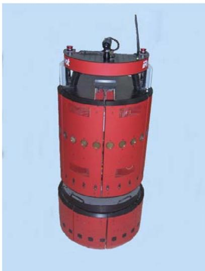
Figure 1.16 : Robot mobile *B21r* à traction synchrone du CDTA
