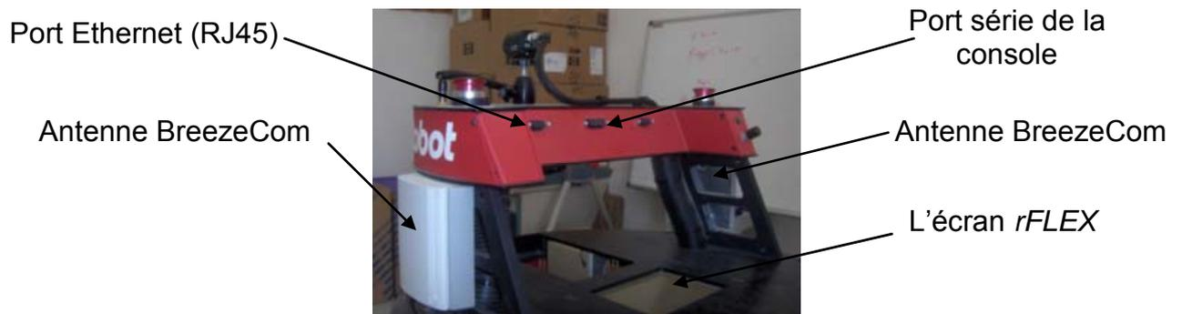
Figure 4.2 Console du Robot *B21r*
