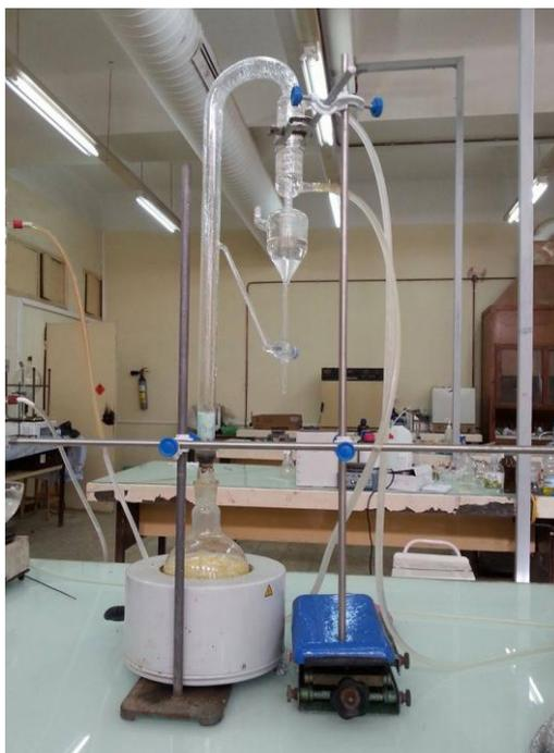
**Figure III.1.** Dispositif d'extraction des huiles essentielle par hydrodistillation.
