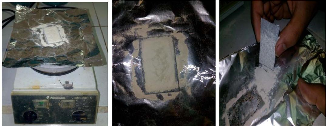
**Figure II-2 :** Photo montrant le processus de déposition des matériaux argileux sur la plaque de verre.
