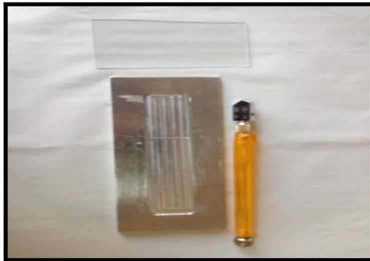
**Figure II-1 :** système de raclette pour la déposition du butime sur la lame de verre
