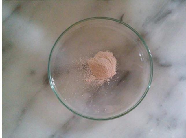
**Figure 5.2.** Acétate de cellulose à base de coton
