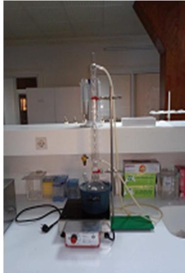
**Figure 5.1.** Montage à reflux
