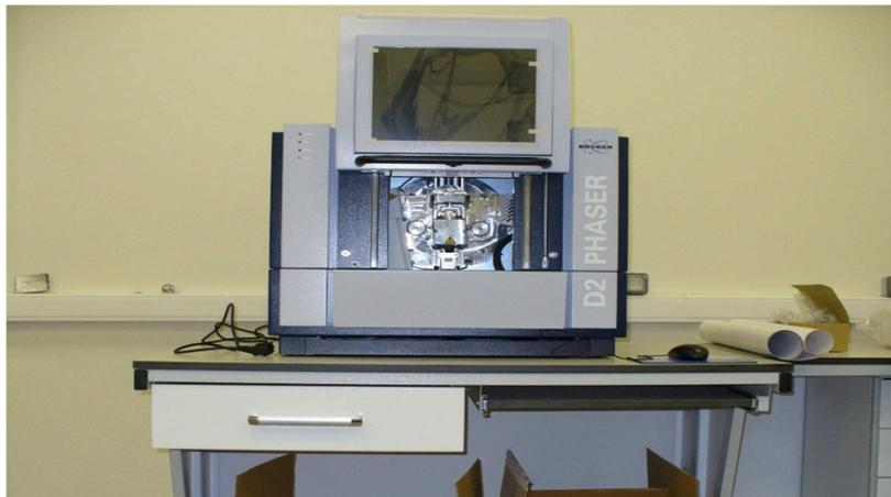
Figure 3.7. XRD BRUKER D2 Phaser
