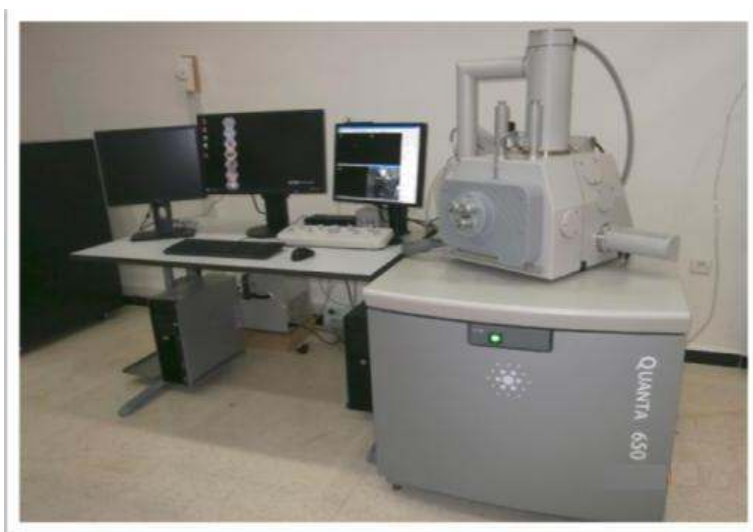
Figure 3 : Le microscope électronique à balayage couplé d'un microanalyseur X "FEI type Quanta 650".
