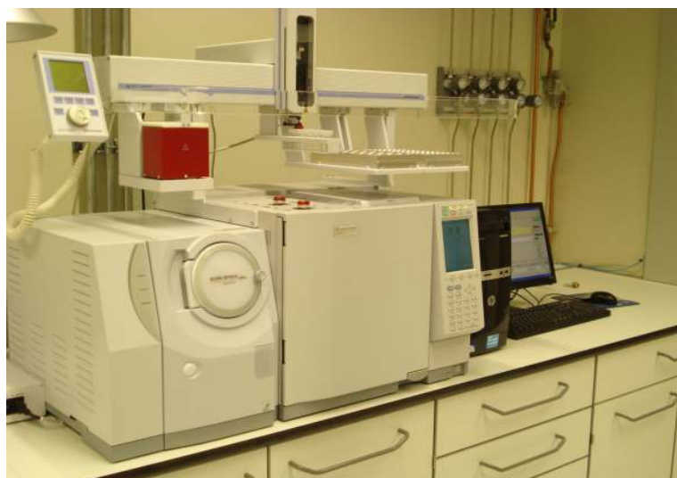
Fig 6 : Le système d'analyse chromatographique en phase gazeuse, "GC-2010", couplé avec un spectromètre de masse "SHIMADZU, modèle GCMS-QP2010 Plus".
