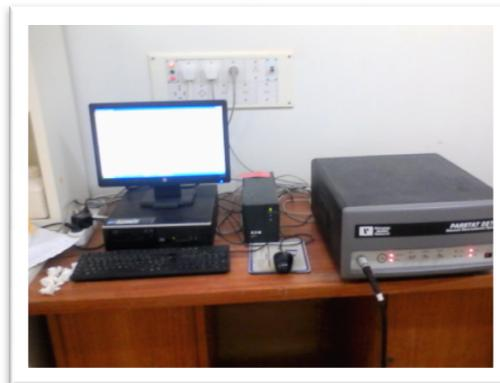
Figure 2.7 : potentiostat de type PARSTAT, Model 2273
