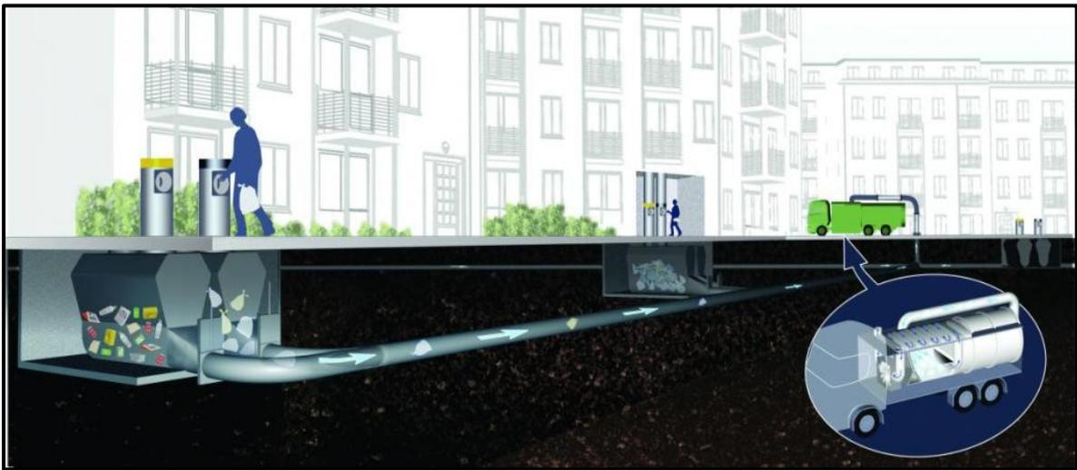
Figure 83. système de collecte de déchets par aspiration.
