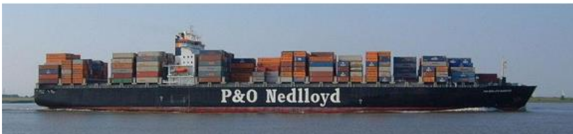
Figure 46: Porte-conteneurs, longueur : 278m, largeur : 42m, tirant d'eau : 15m. Source : http://commons.wikimedia.org/wiki/File:Nedlloyd.Barentsz.jpg
