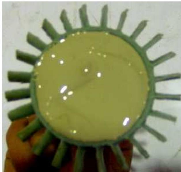
**Figure (3-22) : Modèle en cire enduit de céramique sur sa partie inférieure.**
