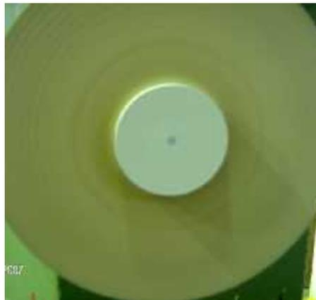
**Figure (3-6) : disque modèle peint emboîté dans l'alésage disque support.**
