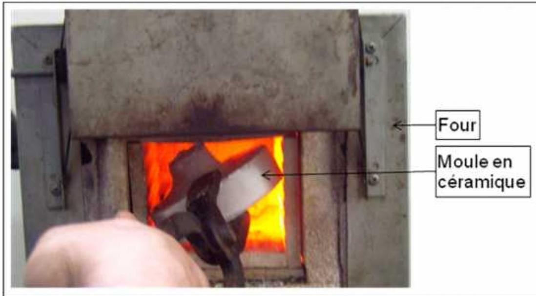
Figure (3-25) : Moule en céramique a la sortie du four.
