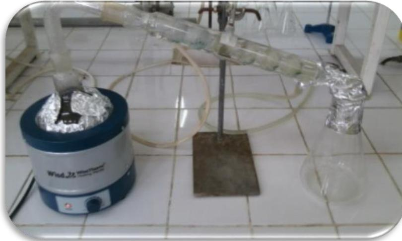
**Figure 3.4 :** Montage de l'hydrodistillation.
