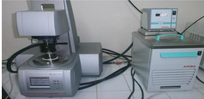
**Figure3.5** : Rhéomètre Anton PaarModular Compact RhéomètreMCR 302.
