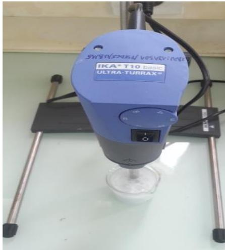
**Figure 3.7 :** Préparation de l'émulsion buvable par un homogénéiseur.
