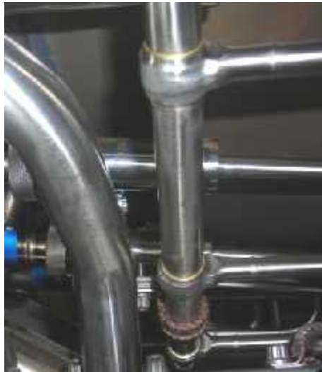
(Fig.III-2-8) la rampe carburant.
