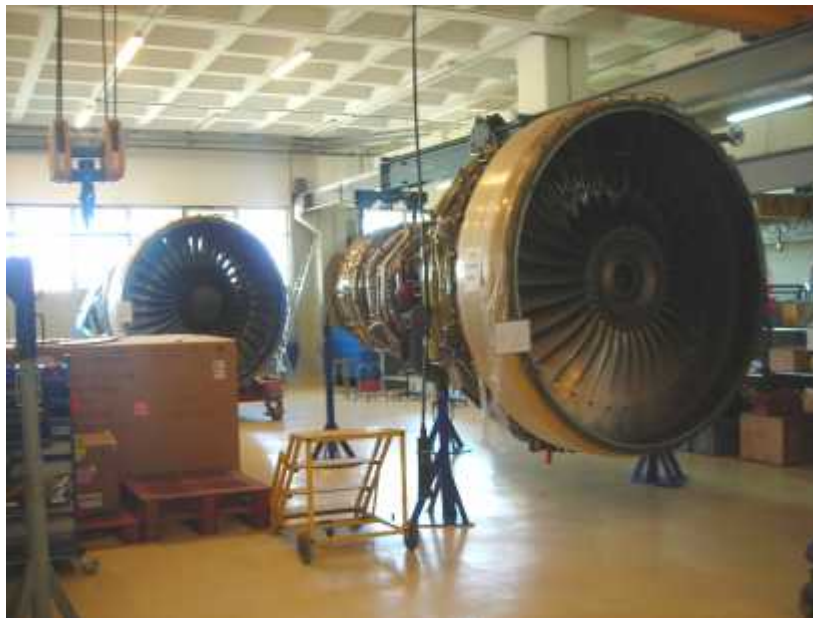
(Fig.IV-1-C) Les deux chantiers du CF6-80E1 au QEC.
