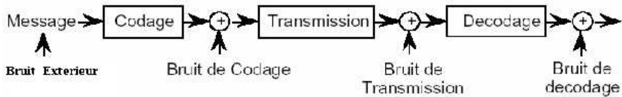
Figure 1.1 : Exemple d'une chaîne de transmission
