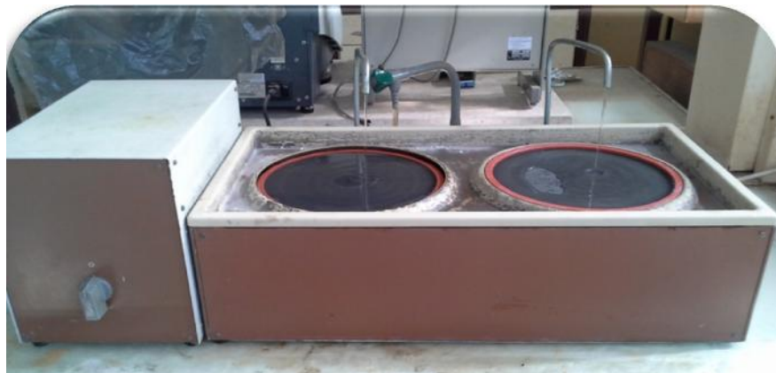
Figure 3.2 : polisseuse sous jet d'eau.
