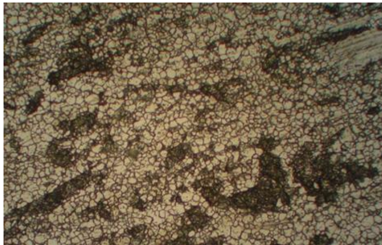
Figure 4.2 Etat de surface avant polissage mécanique (agrandissement 20 fois).
