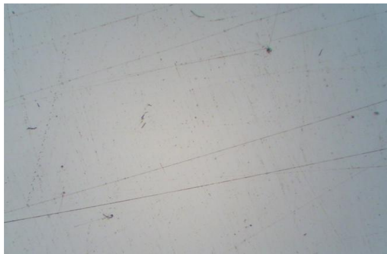
Figure 4.7 Etat final de la surface après électropolissage (agrandissement 20 fois).
