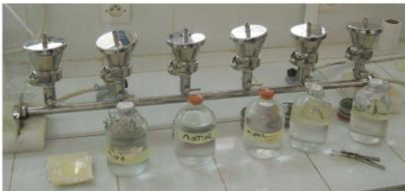
Figure 5.1 : Dispositif de l'appareil de filtration sur membrane.
