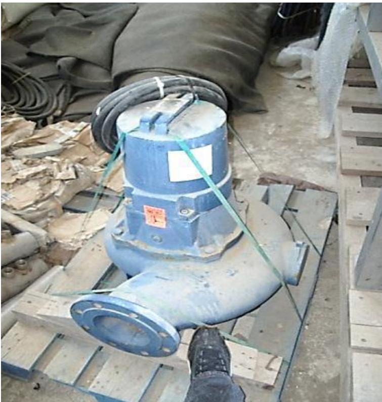
Photo 7 : Pompe immergeable pour la diffusion d'oxygène.
