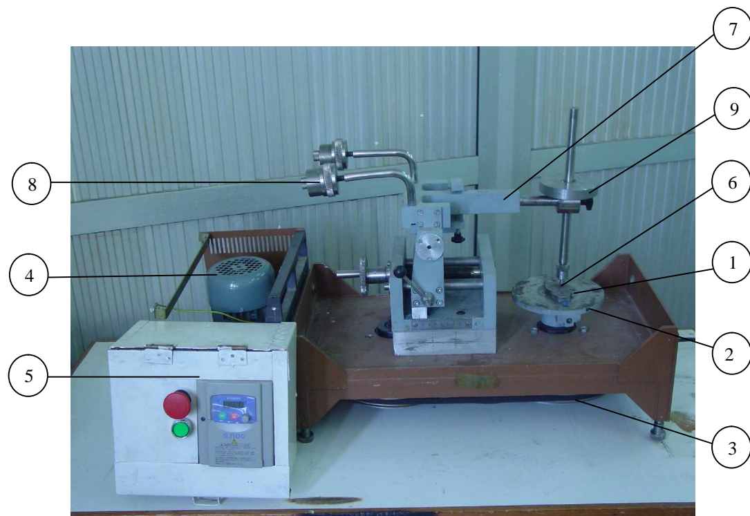
Figure 2. 5 : Dispositif d'essai d'usure type pion sur disque conçu par le laboratoire LTSM Blida.
