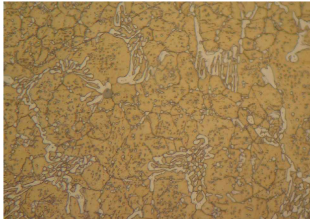
Figure 3. 13 : Microstructure après mise en solution à 1150° C. 1000x
