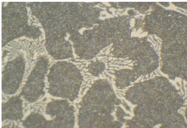
Figure 3. 17 : Microstructure après mise en solution de 2 h à 900° C. et revenu de 6 h à 250° C. 1000x.
