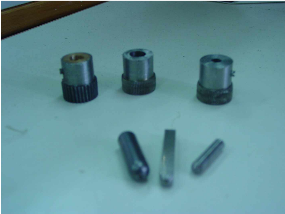
Figure 2. 6 : Porte pion et pions en différents diamètres.
