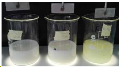
Figure 128 et 139 : Effet de la concentration de TiO_2 Degussa pour une solution à 10 mg/L de CBT G3-P, à sous une agitation rapide 150 rpm, à pH...
