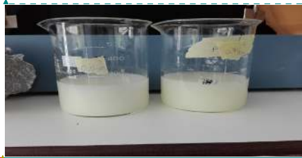
Figure 128 et 139 : Effet de la concentration de TiO_2 Degussa pour une solution à 10 mg/L de CBT G3-P, à sous une agitation rapide 150 rpm, à pH...
