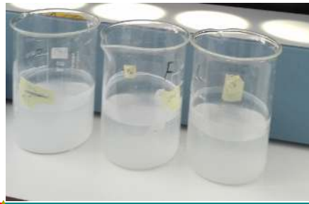
Figure 84 et 95 : Effet de la masse du catalyseur avant et après irradiation pour une suspension de ZnO (gauche : avant irradiation, droite : après irradiation)
