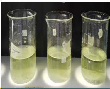
Figure 84 et 95 : Effet de la masse du catalyseur avant et après irradiation pour une suspension de ZnO (gauche : avant irradiation, droite : après irradiation)
