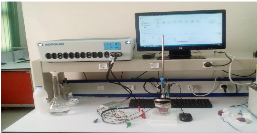
Figure II. 10 : Schéma du dispositif utilisé dans le test électrochimique.
