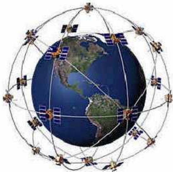
Figure 4.2 : Constellation des satellites du système GPS [64]
