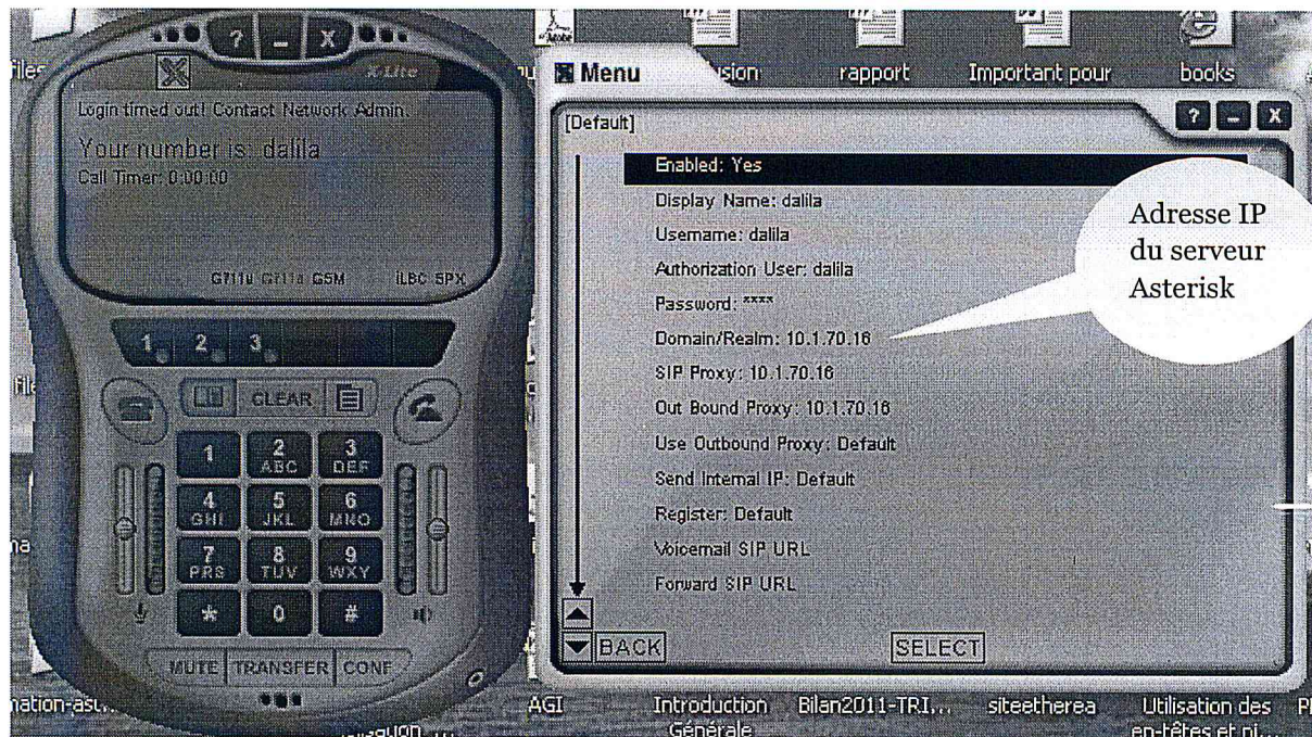
Figure III.9 : Configuration d'un client SIP sur X-lite
