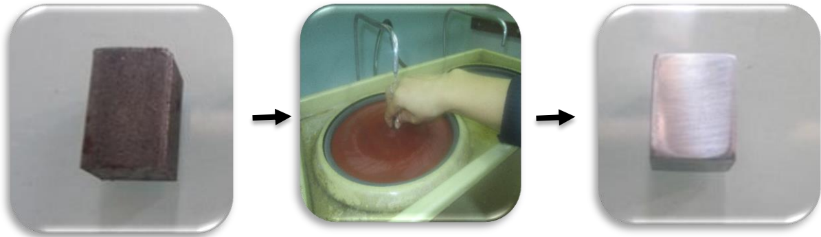
Figure 2.2 : Echantillon avant et après polissage.
