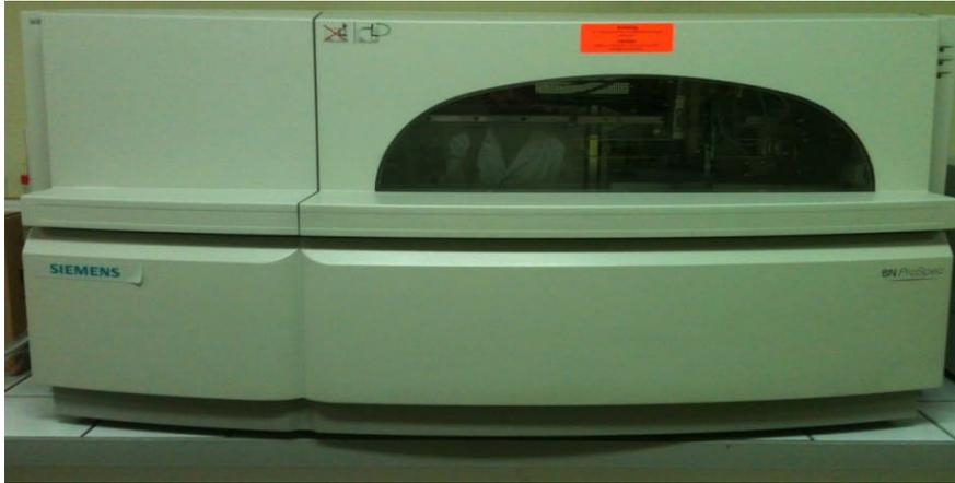
Figure 24 : Représentation du néphélémètre laser.
