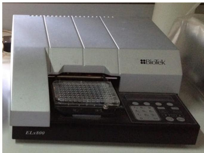
Figure 25 : Spectrophotomètre de type BioTek.
