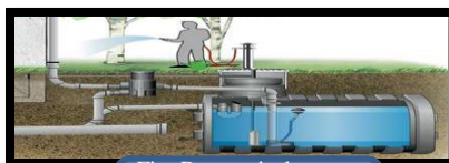
Fig. Reservoir des eaux pluviales
