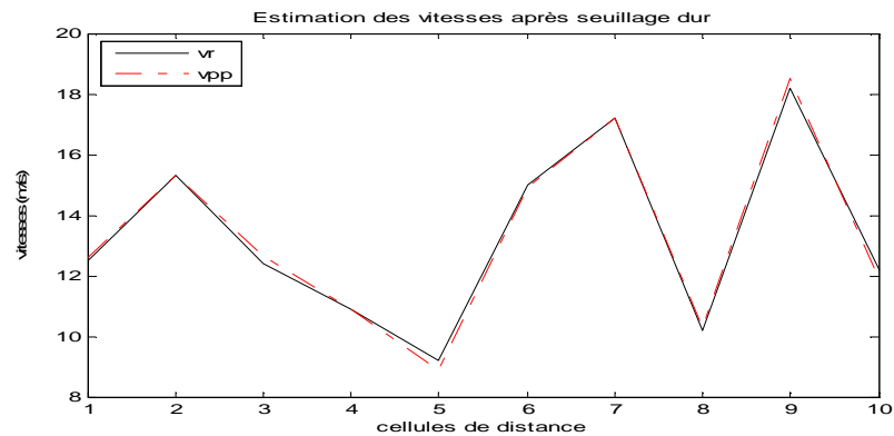
Figure 5.47 : La vitesse radiale moyenne estimée par la méthode ondelettes– Pulse Pair
