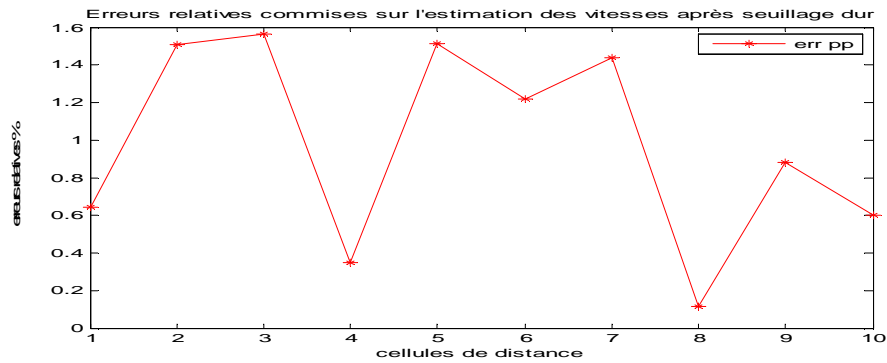
Figure 5.63 : Erreur relative sur l'estimation des vitesses pour chaque porte en distance, méthode Ondelettes– Pulse Pair
