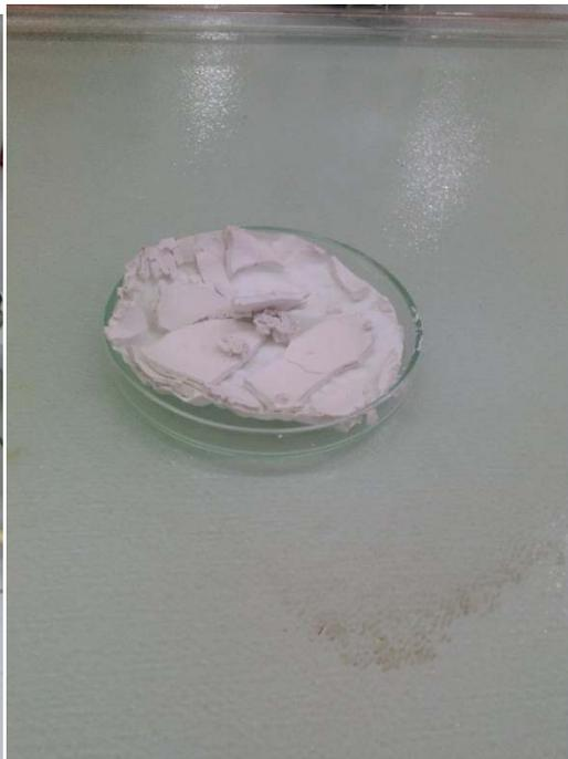
**figure II.6 :** acétate de cellulose après le séchage
