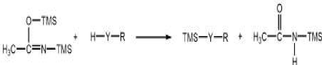
**Figure I.20** : l'équation montrant le sous-produit qui est le triméthylsilyl-acétamide de réactif de silylation bis (triméthylsilyl) -acétamide : TMS = Si (CH<sub>3</sub>)<sub>3</sub>, Y = O, S, NH, NR', COO, R, R' = Alk, Ar [35].
