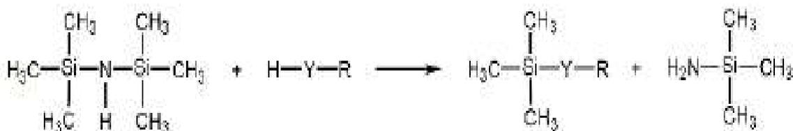
**Figure I.22** : Réaction de silylation à l'aide de Hexaméthylidisilazane (HMDS) : Y = O, S, NH, NR', COO, R, R' = Alk, Ar[36].
