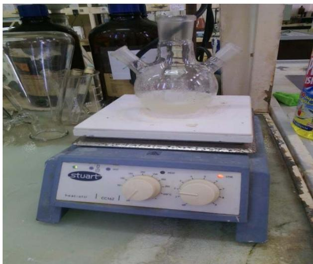
**Figure II.9** : montage de réaction de silylation
