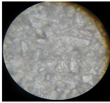
Figure 5.92 : vue microscopique d'une suspension pharmaceutique à base de tabulose G : x 100
