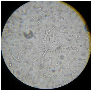
Figure 5.38 : vue microscopique de la Tabulose dans un pH=5,25 G : x 100
