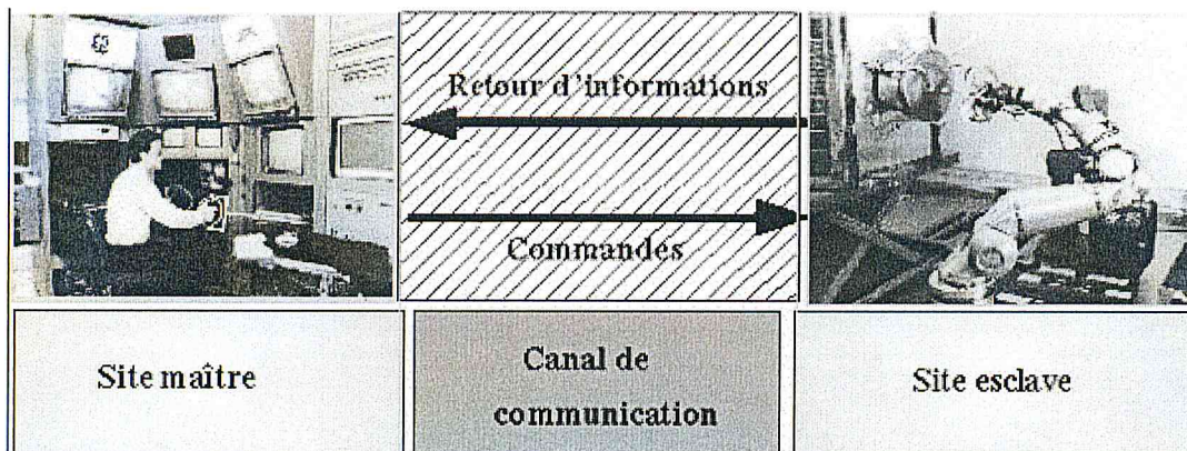
Figure 1: Illustration de l'architecture générale d'un système de téléopération [19]
