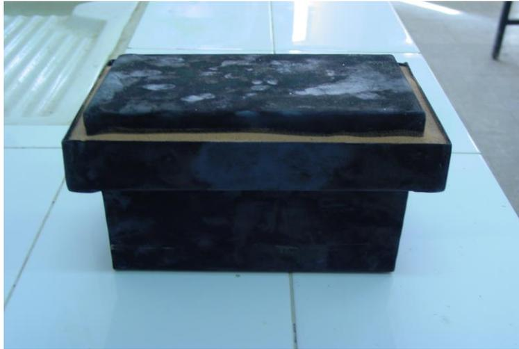
Figure 4.4 : Caisse utilisée pour la boro-carbo-nitruration.
