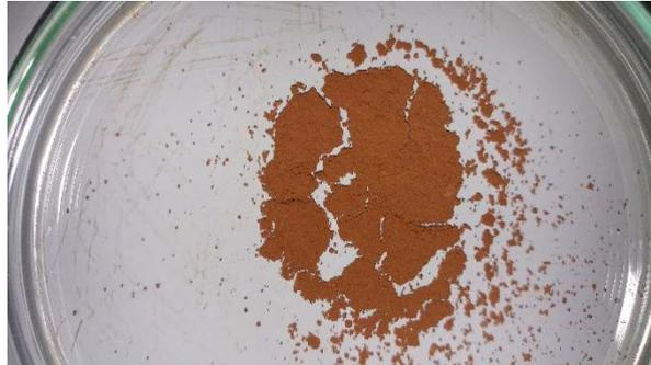
**Figure II.2** :Poudre d'HDL Mg-Fe-CO<sub>3</sub>.
