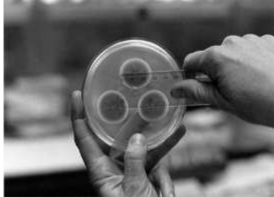
Figure 08. Technique pour mesurer des diamètres de colonie par la lumière transmise (pitt et Hocking 2009).
